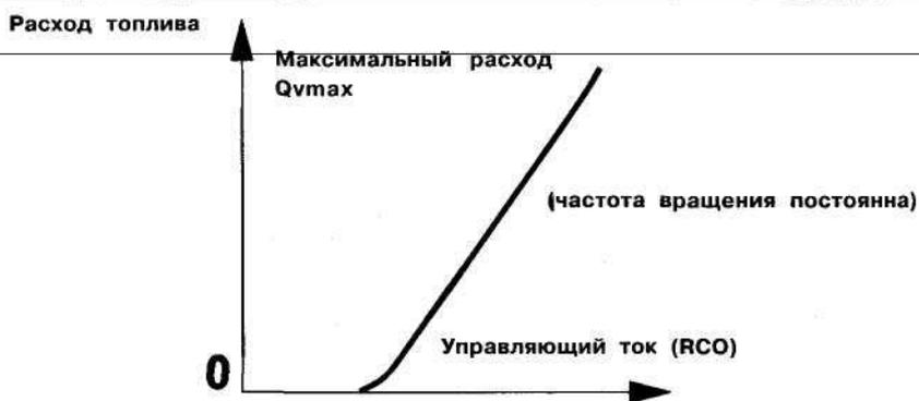
Рис. 7.52е. Выходная характеристика расхода топлива RCO.
