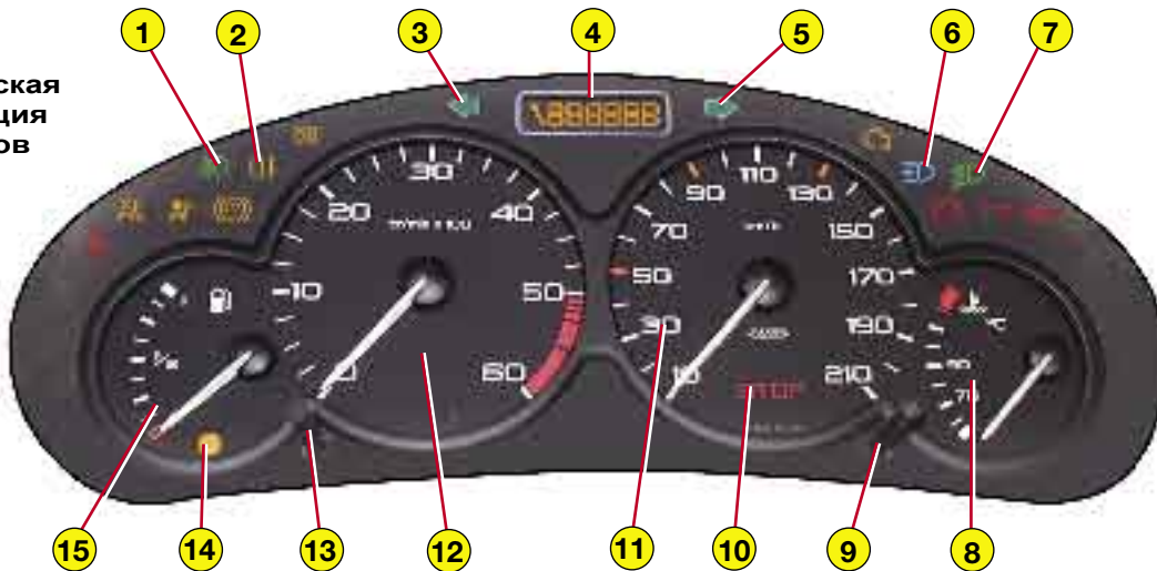
Комбинация приборов с круиз-контролем
