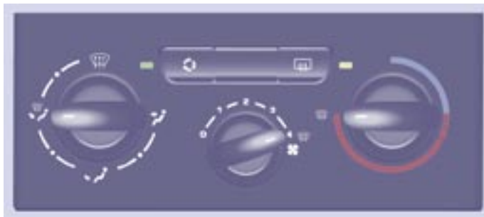
Панель управления отоплением
