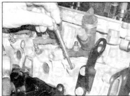
Рис. 2.6. Выверните накаливаемую свечу(-и) и снимите ее с головки цилиндра (показан двигатель 2.0 л со снятой топливной рампой)
