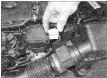
Рис. 12.25. Разъедините электрический разъем датчика расхода воздуха (поздние модели с двигателем 1.9 л)
