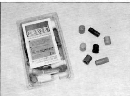
Рис. 2.4. Типовой комплект пластмассовых заглушек и крышек для уплотнения отсоединенных топливопроводов и элементов
