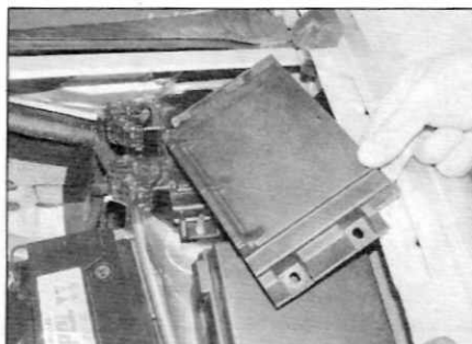
Рис. 12.14, б. ...и снимите крышку БЭУ (поздние модели с двигателем 1.9 л)
