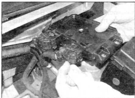
Рис. 12.15. Снимите БЗУ с опорного кронштейна, а затем разъедините электрические разъемы (поздние модели с двигателем 1.9 л)
