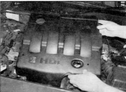
Рис. 3.20, б. ...и снимите крышку двигателя (модели с двигателем 2.0 л)
