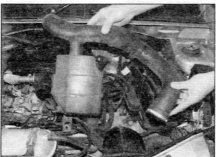
Рис. 3.7, в. ... затем выверните болт крепления резонатора и снимите воздухопровод с двигателя (ранние модели с двигателем 1.9 л)
