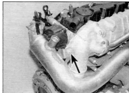
Рис. 3.27. Выверните верхний болт (отмечен стрелкой) крепления жесткого впускного воздухопровода к впускному коллектору (ранние модели с двигателем 2.0 л)
