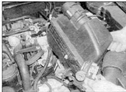
Рис. 3.23, б. ...затем приподнимите заднюю часть корпуса воздушного фильтра и высвободите передние установочные выступы (ранние модели с двигателем 2.0 л)
