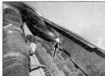
Рис. 3.15. Отверните гайку (отмечена стрелкой) крепления впускного воздухопровода к передней панели кузова (поздние модели с двигателем 1.9 л)
