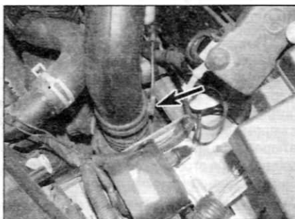
Рис. 3.7, а. Отпустите хомут (отмечен стрелкой) крепления впускного воздухопровода к датчику расхода воздуха...
