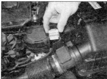
Рис. 3.17. Рассоедините электрический разъем датчика расхода воздуха (поздние модели с двигателем 1.9 л)
