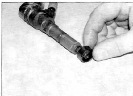
Рис. 15.23, а. Наденьте новое верхнее уплотнение на форсунку...
