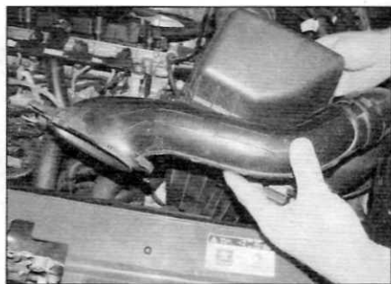
Рис. 3.35, б. ...затем снимите корпус воздушного фильтра и впускной воздухопровод, как единый элемент (поздние модели с двигателем 2.0 л)
