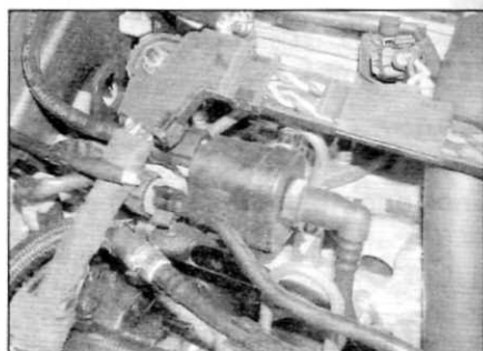
Рис. 12.85. Подогреватель топлива в сборе (модели с двигателем 2.0 л)
