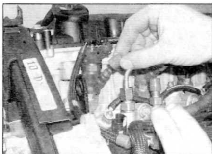
Рис. 16.9, б. Заглушите все соединения, чтобы предотвратить проникновение грязи в топливную систему (модели с двигателем 2.0 л)
