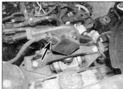
Рис. 12.97. Рассоедините электрический разъем (отмечен стрелкой) датчика положения педали акселератора (поздние модели с двигателем 2.0 л)
