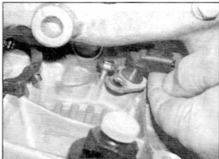
Рис. 12.31, б. ...а затем выведите датчик коленчатого вала из-под болта и снимите его
