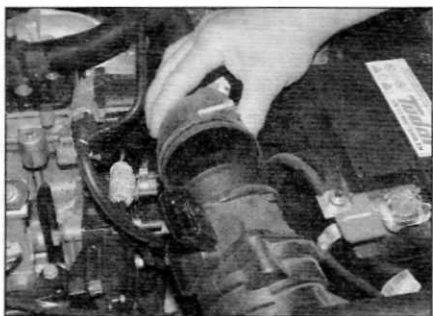
Рис. 3.34. Отпустите хомут и отсоедините гибкий впускной воздухопровод от датчика расхода воздуха (поздние модели с двигателем 2.0 л)
