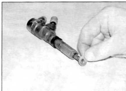
Рис. 15.23, б. ...затем установите новую медную шайбу (модели с двигателем 2.0 л)
