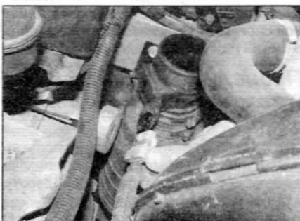
Рис. 3.8. Рассоедините электрический разъем датчика расхода воздуха (ранние модели с двигателем 1.9 л)
