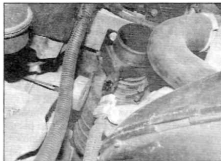
Рис. 12.20. Разъедините электрический разъем датчика расхода воздуха (ранние модели с двигателем 1.9 л)
