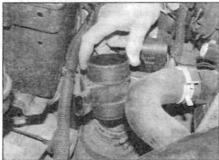
Рис. 12.21. Отпустите хомут и снимите датчик расхода воздуха (ранние модели с двигателем 1.9 л)
