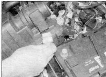
Рис. 3.23, а. Рассоедините электрический разъем датчика расхода воздуха...
