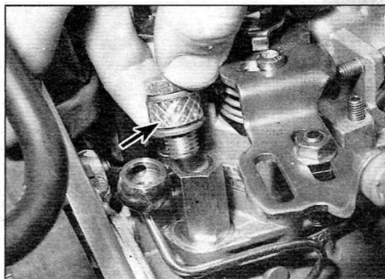
Рис. 5.9, б. Установка болта штуцерного соединения типа «банджо» питающего топливопровода с маленьким куском топливного шланга (отмечен стрелкой) для предотвращения проникновения грязи (насос Bosch)
