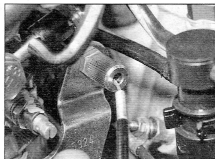
Рис. 4.5. Извлечение троса повышенной частоты вращения холостого хода из регулировочного винта (насос Bosch)
