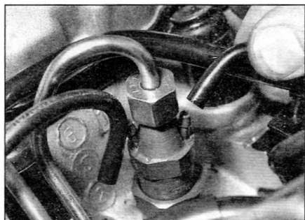
Рис. 10.5. Отсоединение возвратного топливопровода от топливной форсунки
