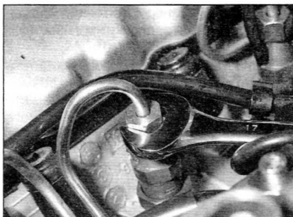
Рис. 10.7. Отвинчивание накидной гайки на топливопроводе форсунки
