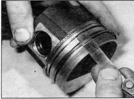
Рис. 13.2. Снятие поршневого кольца с помощью плоского щупа
