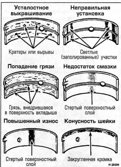
Рис. 15.2. Типичные неисправности подшипников
