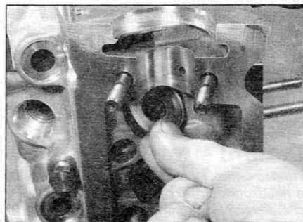
Рис. 7.5, е. ...а затем снимите нижнюю тарелку пружины
