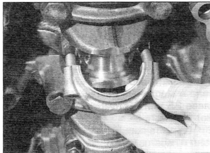
Рис. 10.5. Снятие крышки и вкладыша подшипника нижней головки шатуна
