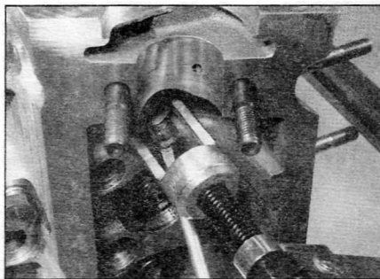
Рис. 7.5, б. ...затем снимите сухари и отпустите съемник пружины...
