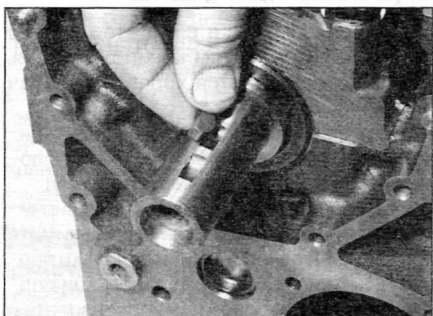
Рис. 11.5, в. ...и снимите сегментную шпонку с коленчатого вала
