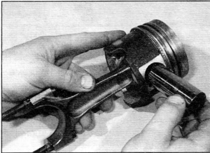
Рис. 13.13, б. ...извлеките поршневой палец
