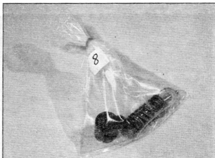
Рис. 7.8. Положите каждый клапан и соответствующие элементы в пакет, снабженный этикеткой
