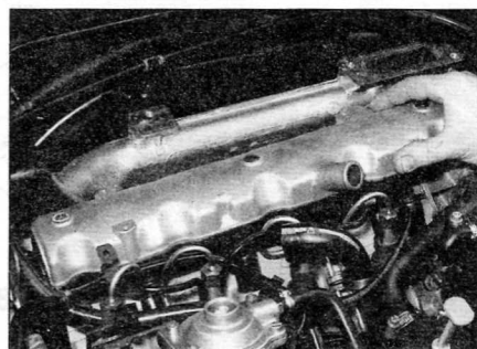
Рис. 4.6. ...и снимите крышку головки цилиндров
