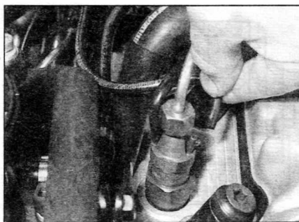
Рис. 13.5. Отсоединение возвратного шланга топливных форсунок
