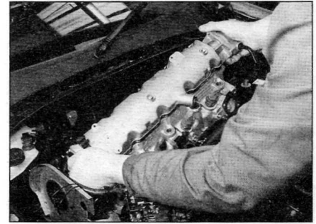
Рис. 13.22. Снятие головки цилиндров
