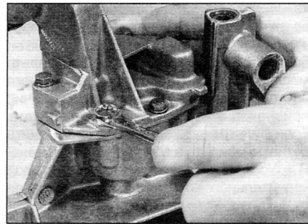
Рис. 15.5, а. Выверните болты крепления крышки масляного насоса...
