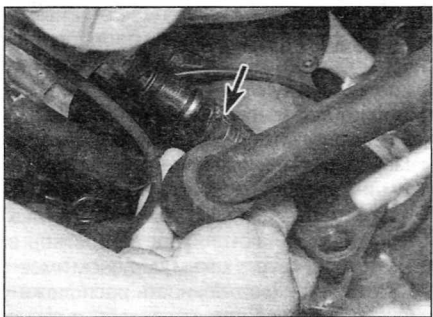
Рис. 13.8. Отсоединение шланга охлаждающей жидкости (отмечен стрелкой) от задней части головки цилиндров
