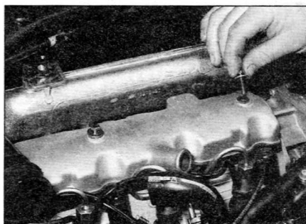
Рис. 4.4. Выверните болты и снимите их вместе с шайбами...
