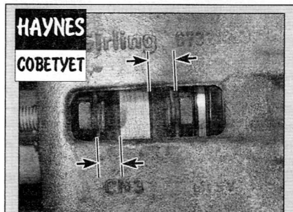
Быструю проверку толщины фрикционного материала на каждой тормозной колодке можно выполнить через проем в тормозном суппорте.
