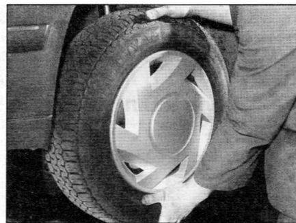
Рис. 18.4. Для проверки подшипников ступицы на наличие износа возьмитесь за колесо сверху и снизу и попытайтесь покачать его
