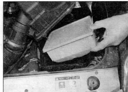
Рис. 20.15. Снимите крышку и извлеките фильтрующий элемент (поздние двигатели серии DW)
