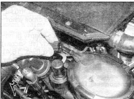
Рис. 19.11. Отпустите зажим и отсоедините выпускной топливопровод от крышки корпуса фильтра (двигатели 1.9 л серии DW)
