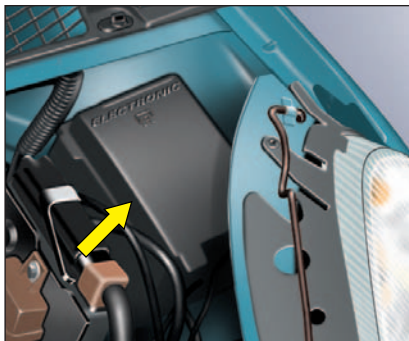
Предохранители в моторном отсеке
