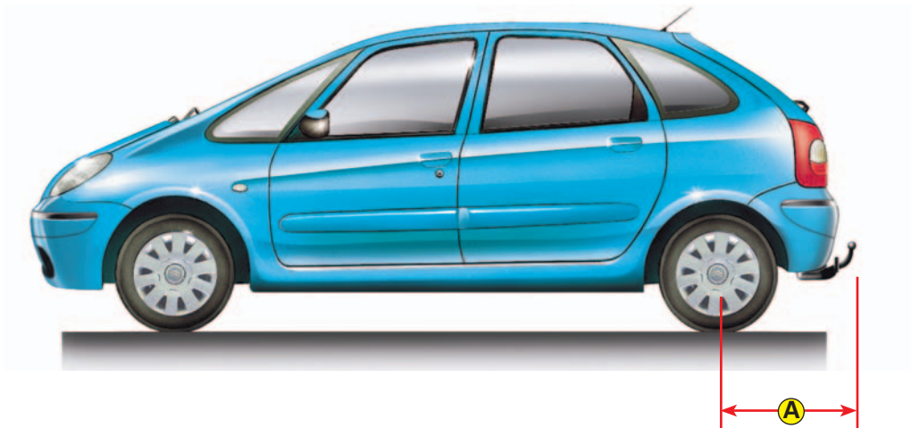
A Габаритные размеры (в метрах): 0,792.
