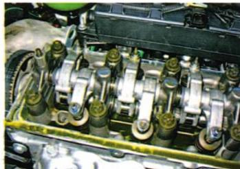
● Регулировка зазоров в клапанном механизме мотора TU3 требуется нечасто. Процедура сравнительно проста: отпустив контргайку, вращаем винт на коромысле (как на «москвичах»).
