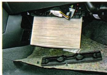
● Лючок салонного фильтра сдвигаем от центра машины и, сняв его, вынимаем элемент вниз. На некоторых версиях лючок дополнительно зафиксирован саморезом.
