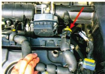
● Вид на поликлиновый ремень снизу. Ослабляем натяжение ремня поворотом болта натяжного ролика (стрелка). При этом будьте осторожны – не пораньтесь о близко расположенный лонжерон.
