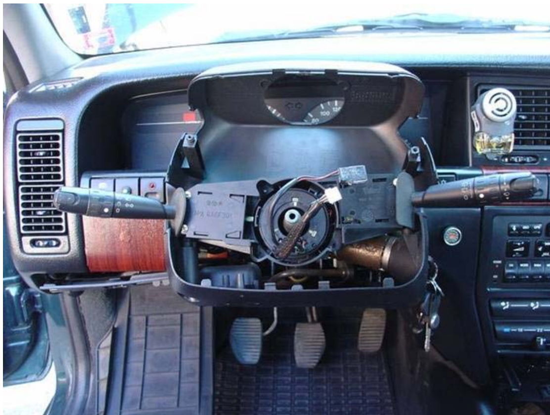
Развиват се винтовете на пластмасовата кора под табло, и се отстраняват.
