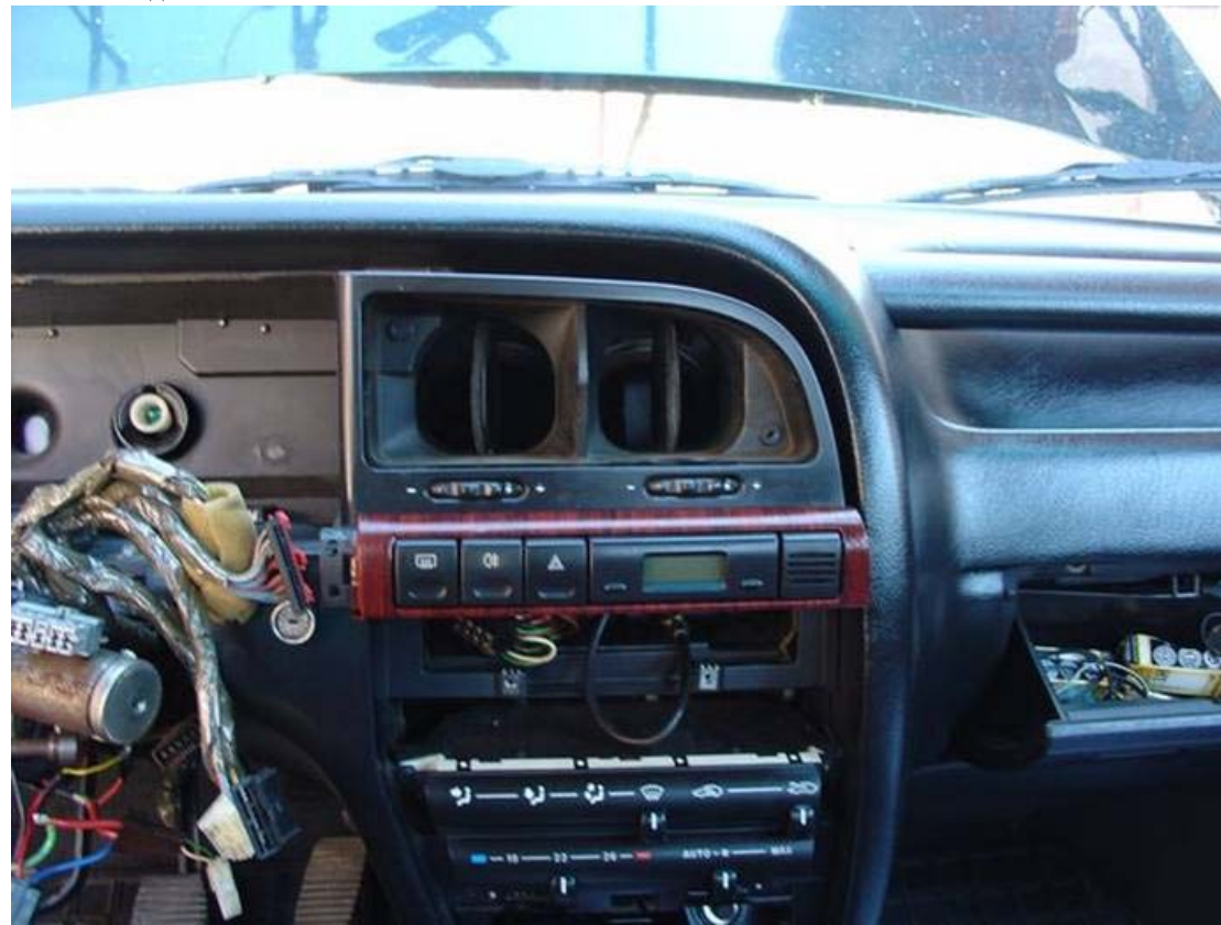
Панела излиза от мястото си. Надписвате всички куплунзи, и се преминава към управляващия панел на парното.
