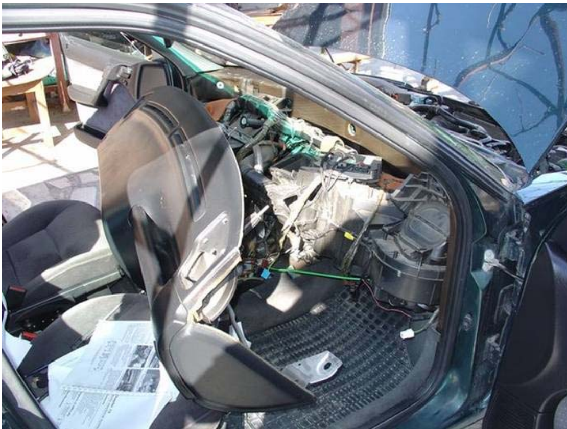
Маха се и модула за управление на парното
