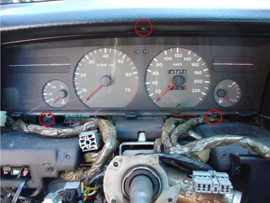
Таблото е закрепено с 3 винта (оградени с червено на снимката)
