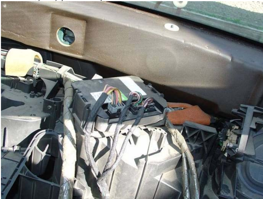
Сега трябва да се измести кабелния сноп който е най отгоре
