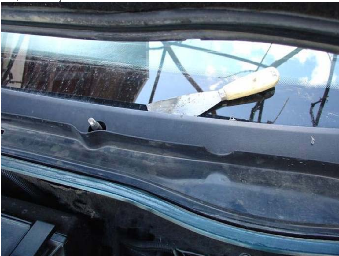
Сваля се и моторчето на чистачките. След това се развиват 3 гайки. Тази е едната,
