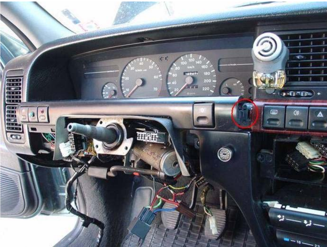
Изтеглете внимателно хоризонталния панел, като внимавате за щипката (оградена с червено на снимката)
