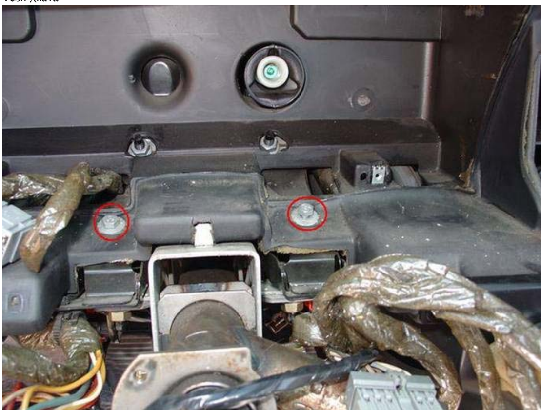
И този, а там където сочи стрелката, има още един болт, който аз забравих, и в следствие пластмасата се счупи, но успях да залепя.
