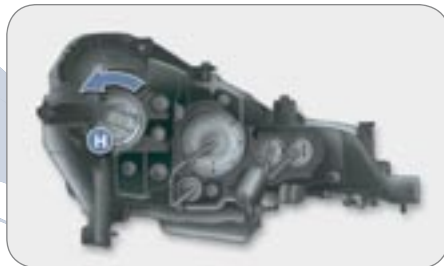
Замена ламп в стояночных фонарях (3)
