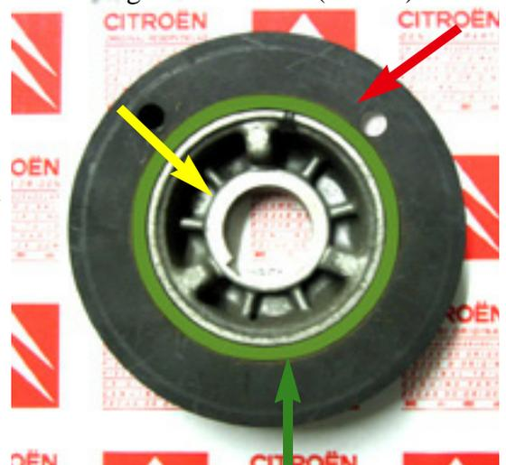
L'explication de ceci réside dans le fait que la PA est constituée de 2 pièces : un moyeu et une couronne, et entre les 2, une bague caoutchoutée qui autorise un certain glissement de la couronne sur le moyeu, peut-être sous les actions répétées de l'embrayage électro-magnétique du compresseur de climatisation
