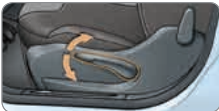
2. Регулировка по высоте.
