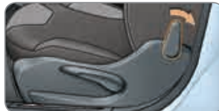
3. Регулировка наклона спинки.
