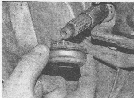
Рис. 6.2. Снимите подшипник выключения сцепления с первичного вала
