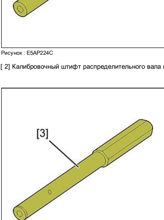
Рисунок : E5AP224C [ 2 ] Калибровочный штифт распределительного вала (-).0194.B.
