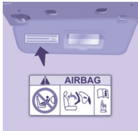
Отключение подушки безопасности пассажира ("OFF")
