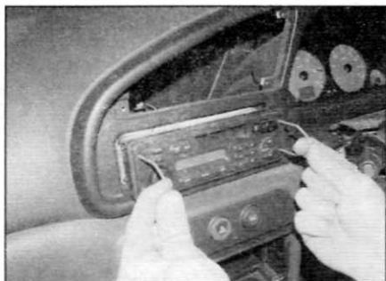
Рис. 17.3. Вставьте съемники в отверстия на аудиоблоке и извлеките блок из лицевой панели
