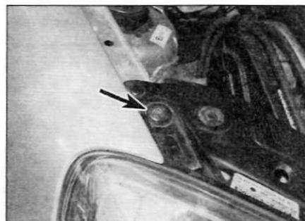
Рис. 7.10, в. ...и верхний винт (отмечен стрелкой) крепления фары (поздние модели)
