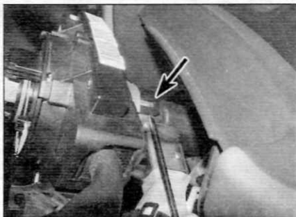
Рис. 4.11, б. ...аккуратно отведите защелки (отмечены стрелками) в стороны от колонки...
