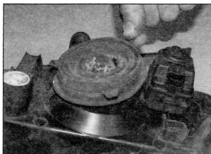
Рис. 5.2. Снимите с фары защитную резиновую крышку (ранние модели)
