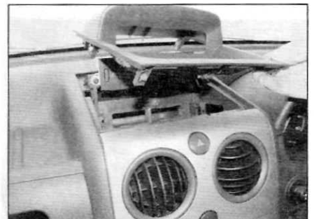
Рис. 10.1. Аккуратно снимите обрамление многофункционального дисплея с лицевой панели
