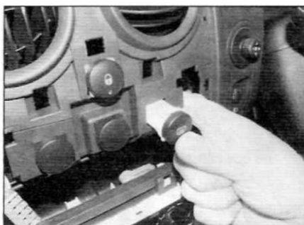
Рис. 4.18. Для снятия нижних переключателей заведите руку в проем на лицевой панели и вытолкните переключатель (поздние модели)
