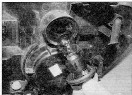
Рис. 5.25, а. Поверните патрон лампы указателя поворота против часовой стрелки, чтобы высвободить его
