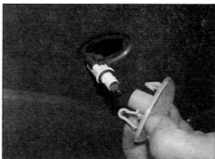
Рис. 5.28, а. Поверните патрон лампы против часовой стрелки, чтобы высвободить его
