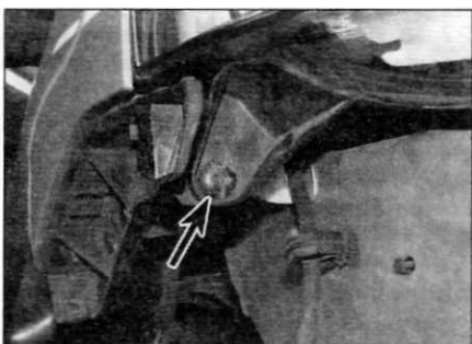
Рис. 7.10, б. ...нижний внешний винт (отмечен стрелкой)...
