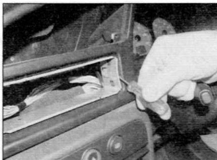
Рис. 17.5. На ранних моделях с помощью маленькой отвертки отпустите установочные выступы рамы...
