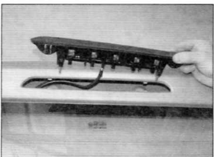
Рис. 5.44, а. Снимите верхний стоп-сигнал...
