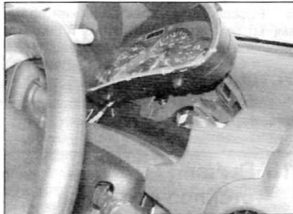
Рис. 9.11, б. ...затем приподнимите щиток и снимите его (поздние модели)
