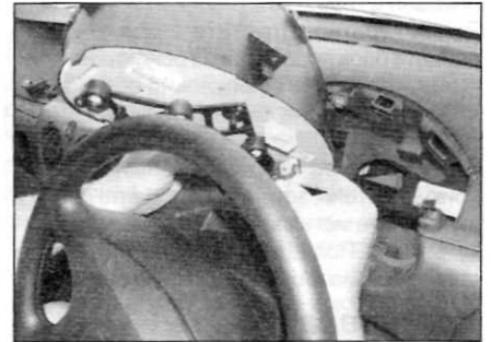
Рис. 9.12. Переверните щиток приборов и разъедините электрические разъемы (поздние модели)
