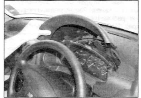
Рис. 9.10, б. Отцепите верхние установочные выступы от лицевой панели и снимите панель (поздние модели)
