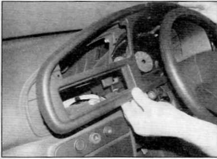
Рис. 9.7. Потяните верхнюю панель на себя, чтобы отпустить фиксаторы (ранние модели)
