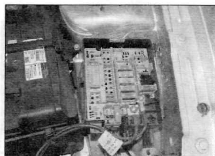
Рис. 3.2, б. ...и в коробке плавких предохранителей/реле моторного отделения
