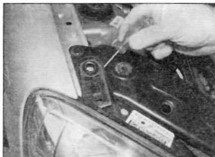
Рис. 7.11. Слегка приподнимите верхний опорный рычаг, чтобы отцепить стопорную лапку, и снимите фару (поздние модели)
