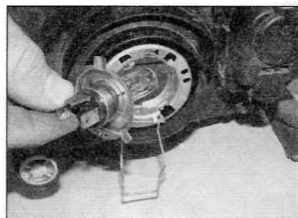
Рис. 5.3, б. ...и извлеките лампу (ранние модели)
