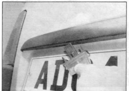
Рис. 5.57, б. ...и вытолкните фонарь из двери (модели с двухстворчатой дверью багажного отделения)
