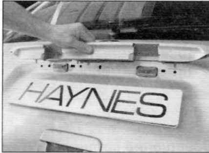
Рис. 5.51. Снимите внешний молдинг над фонарем освещения номерного знака (модели с поднимаемой дверью багажного отделения)
