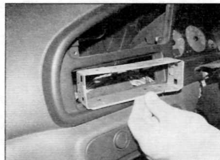
Рис. 17.6. ...затем извлеките опорную раму из лицевой панели
