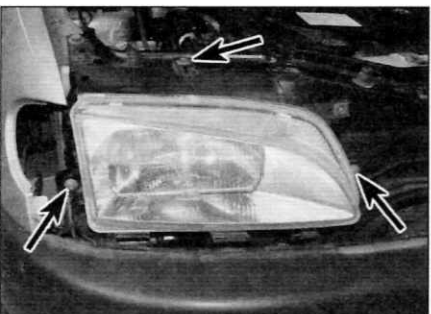
Рис. 7.3. Выверните три болта (отмечены стрелками) и снимите фару
