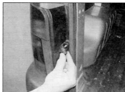
Рис. 5.38. Отверните пластмассовую гайку крепления заднего фонаря к кузову
