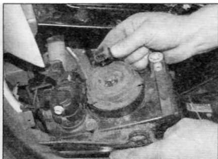
Рис. 7.4. Рассоедините электрические разъемы и снимите фару (ранние модели)
