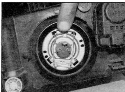
Рис. 5.3, а. Отпустите пружинный зажим...
