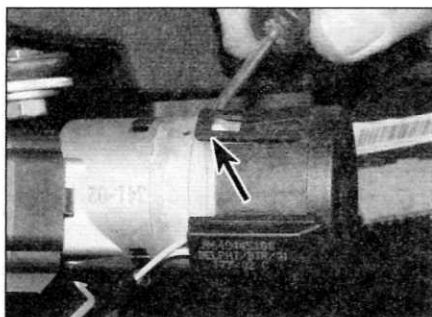
Рис. 19.4. Высвободите приемопередатчик иммобилайзера и извлеките его из цилиндра выключателя зажигания
