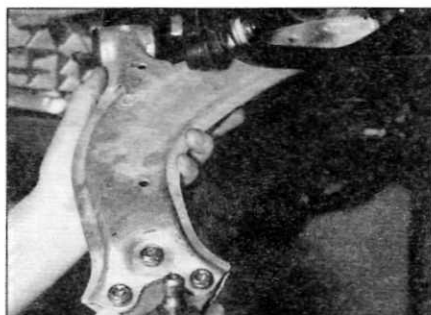
Рис. 6.6. ...затем снимите нижний рычаг с автомобиля
