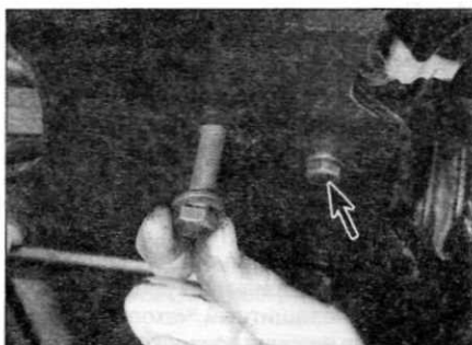
Рис. 6.4. ...и два болта крепления задней опорной втулки (второй болт отмечен стрелкой)...
