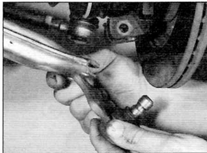
Рис. 7.5, б. ...и снимите шаровой шарнир нижнего рычага
