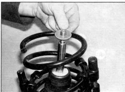
Рис. 5.8, д. Установите плоскую шайбу...
