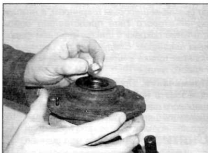
Рис. 5.8, л. ...а затем наверните и затяните гайку штока поршня
