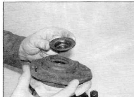
Рис. 5.8, и. Установите на опорную пластину дистанционное кольцо...
