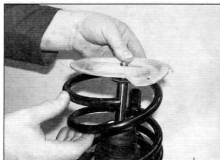
Рис. 5.8, е. ...верхнюю тарелку пружины...
