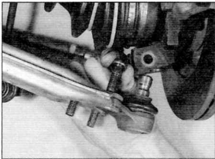
Рис. 7.5, а. Извлеките три болта...
