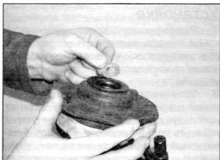
Рис. 5.8, к. ...установите верхнюю шайбу...
