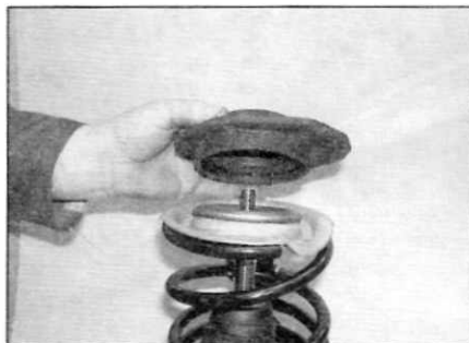
Рис. 5.8, з. ...и опорную пластину
