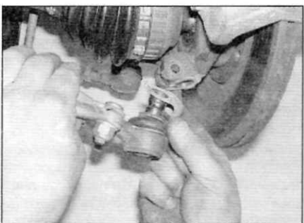
Рис. 2.11. При отпуске шарового шарнира снимите защитную пластину с пальца шарового шарнира
