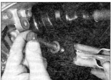
Рис. 6.3. Извлеките болт переднего шарнира нижнего рычага...
