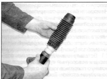
Рис. 5.8, б. Установите пылезащитный чехол поршня...
