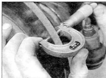
Рис. 6.3. Измерьте микрометром толщину диска
