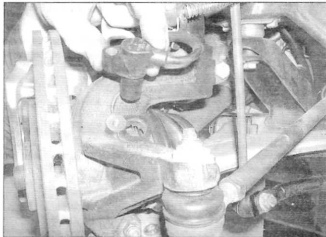
Рис. 20.18, б. ...и снимите датчик переднего колеса с поворотного кулака
