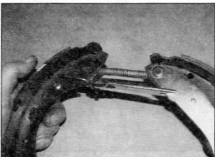
Рис. 5.18. Зафиксируйте стойку регулятора на первичной тормозной колодке и рычаге привода стояночного тормоза
