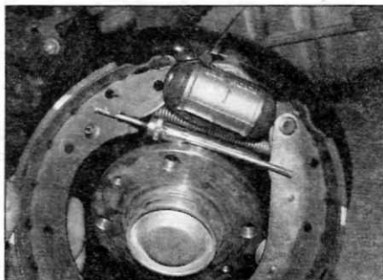
Рис. 5.20. Установите частично собранный узел тормозных колодок на щит тормоза
