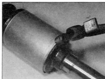
Рис. 3.26, в. ...и зачеканьте крышку по периметру
