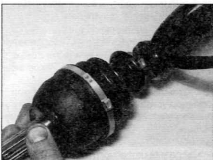
Рис. 3.10. Фиксация хомута чехла с помощью бокорезов
