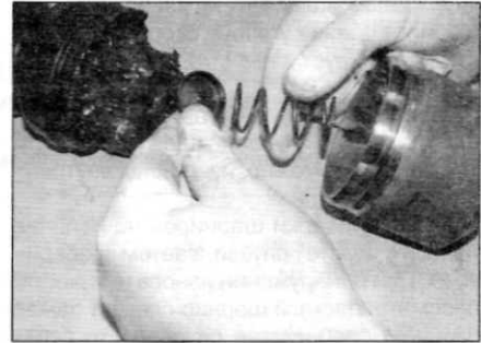
Рис. 4.22, е. Установите пружину и упорный колпачок в наружный элемент...
