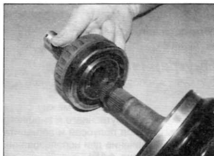
Рис. 4.12, е. Надвиньте шарнир на шлицевой конец и подведите внутренний элемент к хомутику
