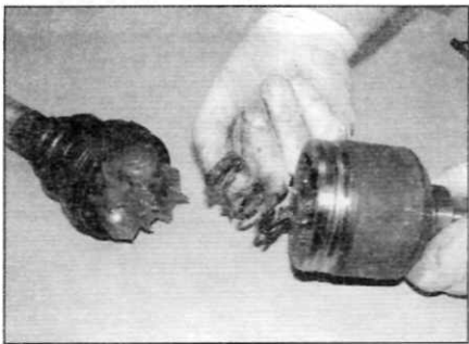
Рис. 4.17, б. ...и извлеките пружину и упорный колпачок из наружного элемента
