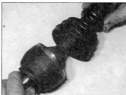
Рис. 3.7. Надвиньте чехол внешнего шарнира на полуось
