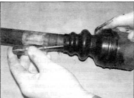
Рис. 4.22, и. Полностью насадите наружный элемент на трипод и приподнимите внутренний край чехла, чтобы выпустить из-под него воздух
