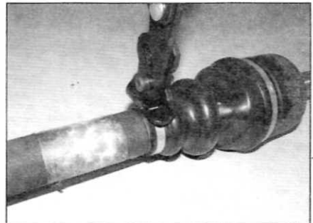
Рис. 4.22, л. Расположите внутренний конец чехла согласно размеру, записанному при снятии, надвиньте хомут и обожмите выступающую часть
