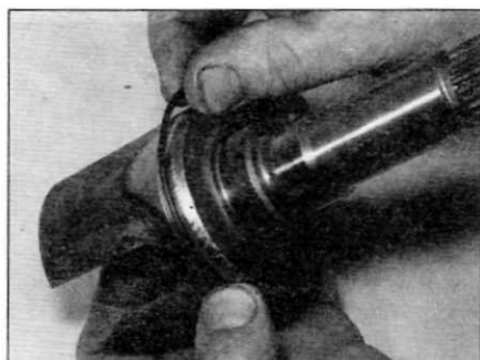
Рис. 3.25, в. ...и уплотнительное кольцо
