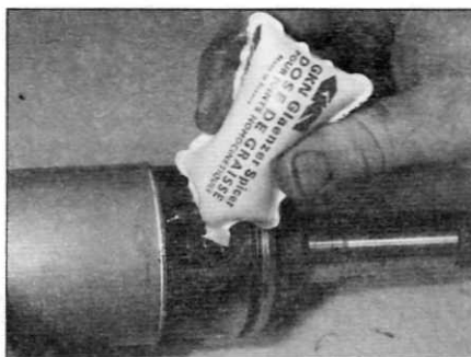
Рис. 3.26, б. ...затем выдавите остаток смазки...
