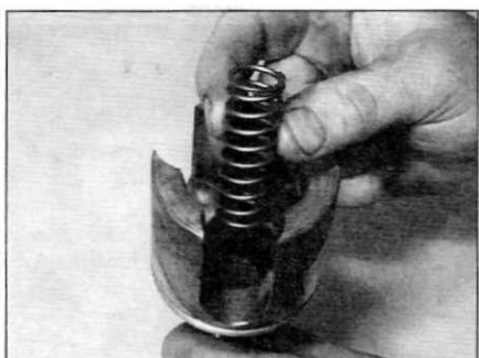
Рис. 3.25, а. Установите новую пружину...
