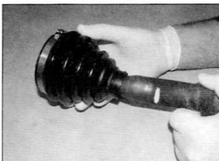
Рис. 4.12, б. ...затем новый чехол с внешним хомутом
