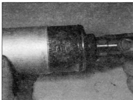
Рис. 3.26, а. Установите наружный элемент на трипод...
