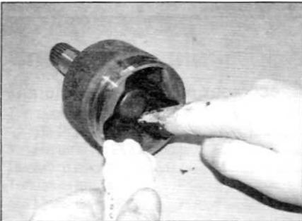
Рис. 4.22, ж. ...затем набейте в наружный элемент остаток смазки
