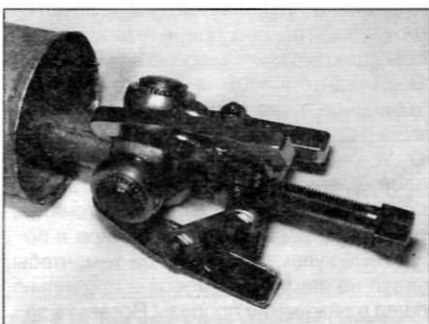
Рис. 3.17, а. Используя съемник с тремя захватами, снимите трипод внутреннего шарнира
