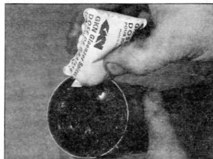
Рис. 3.24. Набейте шарнир и чехол/крышку смазкой
