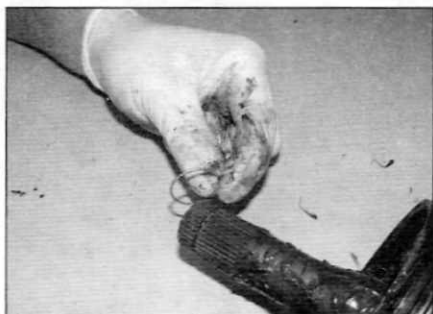
Рис. 4.6. Извлеките стопорное кольцо из канавки на шлицевом конце полуоси
