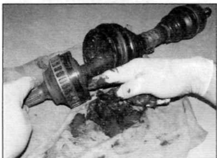
Рис. 4.4. Снимите чехол с полуоси и удалите излишек смазки
