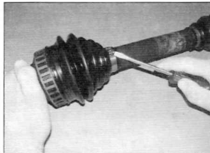
Рис. 4.3, а. С помощью отвертки отпустите внутренний хомут...
