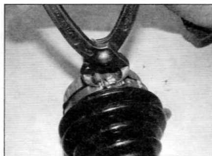
Рис. 4.12, о. Аналогично зафиксируйте внешний хомут чехла
