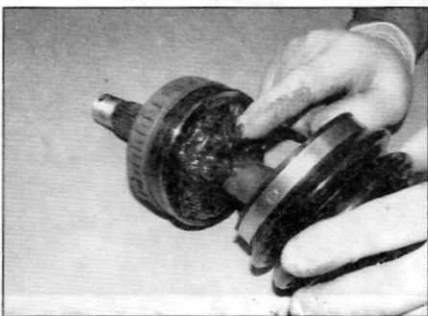
Рис. 4.12, к. ...введите смазку в дорожки для шариков, поворачивая при этом шарнир
