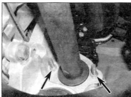
Рис. 2.13. На правой полуоси отпустите гайки на болтах крепления промежуточной опоры (отмечены стрелками), а затем поверните болты на 90°
