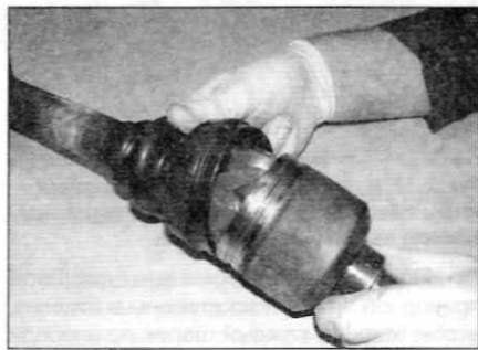
Рис. 4.17, а. Снимите наружный элемент шарнира с трипоида...
