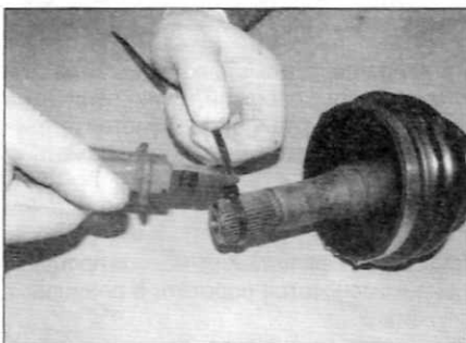
Рис. 4.12, д. Используя бокорезы, затяните хомутик как можно сильнее, а затем отрежьте концы
