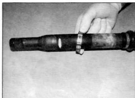
Рис. 4.12, а. Наденьте новый внутренний хомут чехла на полуось...
