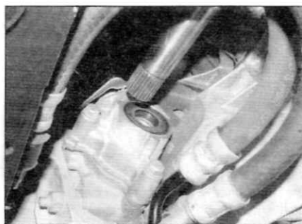
Рис. 2.15. Высвободите внутренний конец полуоси из коробки передач и промежуточный подшипник из соответствующего опорного кронштейна
