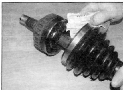
Рис. 4.12, и. Набейте шарнир рекомендуемой смазкой; возьмите половину от предписанного количества смазки...
