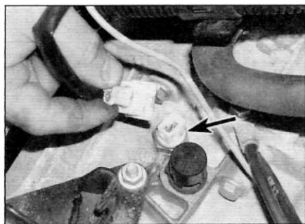
Рис. 5.5, а. Расположение выключателя фонарей заднего хода (отмечен стрелкой) на коробке передач MA5...
