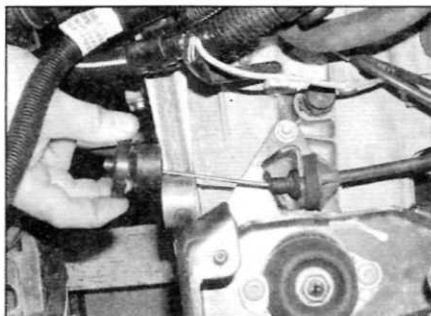
Рис. 2.3, а. На коробках передач MA5 и BE3/5 высвободите наконечник троса сцепления из вилки/рычага выключения...
