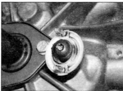
Рис. 5.6, в. ...а затем выверните шпильку с шаровым наконечником (коробка передач ВЕ4/5)
