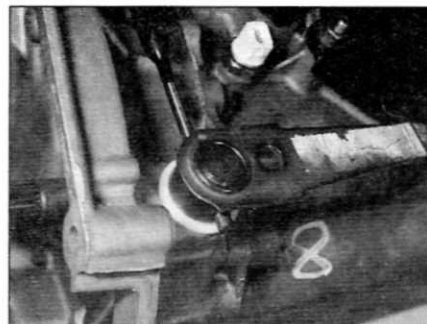
Рис. 5.4, а. Выбейте цилиндрический штифт подходящим кернером...
