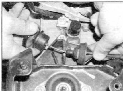
Рис. 2.3, б. ...затем нажмите на фиксирующие элементы и высвободите оболочку троса из опорного кронштейна на коробке передач
