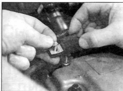
Рис. 3.8, а. Снимите подавитель радиопомех с правого конца блока катушек...
