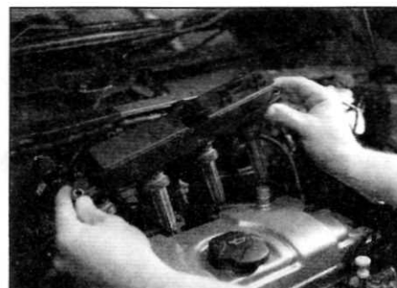
Рис. 3.10. Снимите блок катушек зажигания с опорных шпилек
