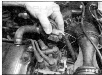
Рис. 3.3. Отсоедините провода высокого напряжения от клемм катушки
