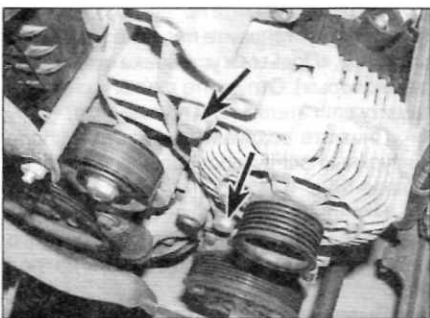
Рис. 8.7. Болты крепления передней части генератора (отмечены стрелками) (показан бензиновый двигатель)
