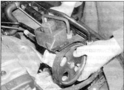
Рис. 8.4, в. ...а затем сдвиньте насос усилителя рулевого управления в сторону (показан бензиновый двигатель)
