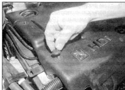
Рис. 8.3, г. На дизельных двигателях 2.0 л поверните каждый фиксатор на 90°, чтобы отпустить...
