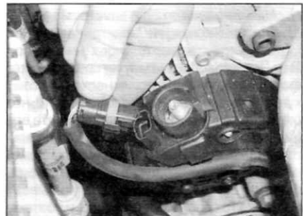
Рис. 8.6, б. ...и рассоедините электрический разъем на генераторе (показан бензиновый двигатель)
