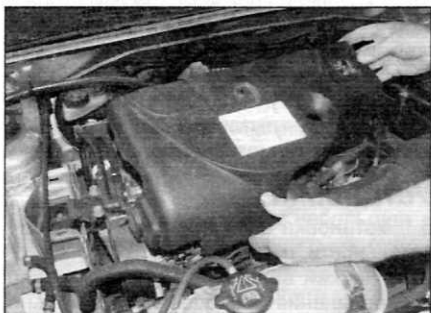
Рис. 8.3, в. ...затем снимите крышку с двигателя
