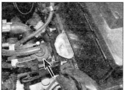
Рис. 3.32. Расположение электромагнитного клапана EGR (отмечен стрелкой) на опорной пластине аккумулятора (модели с двигателем 2.0 л)
