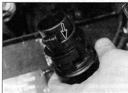
Рис. 2.17. При установке наденьте новое уплотнительное кольцо (отмечено стрелкой) на штуцер шланга
