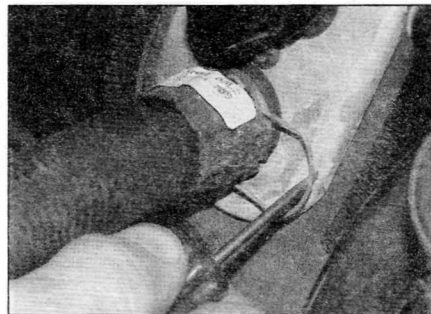
Рис. 10.13, а. Если шланги отопителя подсоединены по отдельности, снимите зажим и отсоедините шланги от штуцеров трубопроводов радиатора отопителя
