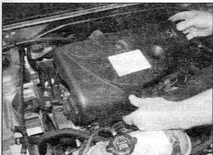
Рис. 4.2, в. ...затем снимите крышку с двигателя
