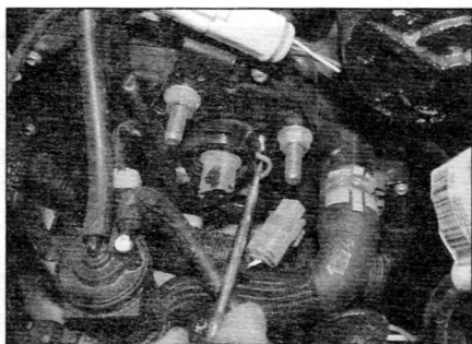
Рис. 6.15. На более поздних моделях снимите стопорное кольцо датчика, затем снимите датчик и уплотнительное кольцо с корпуса
