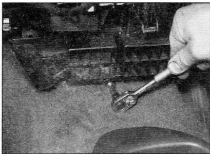
Рис. 10.17. Выверните болт крепления нижней части отопителя к кронштейну на полу
