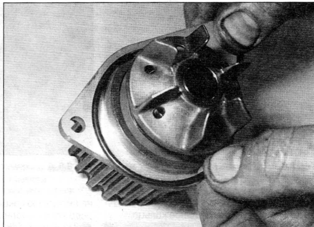
Рис. 7.4, б. ...и снимите уплотнительное кольцо (показан бензиновый двигатель 1.4 л)
