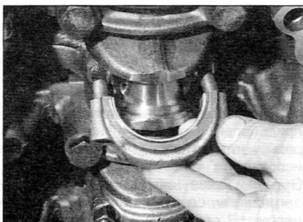
Рис. 9.5. Снимите вкладыш и крышку подшипника нижней головки шатуна
