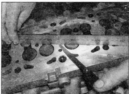
Рис. 7.5. Проверьте сопрягаемую поверхность головки цилиндров на наличие деформации
