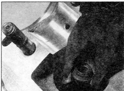
Рис. 6.7. Снимите пассатижами маслоотражательный колпачок клапана
