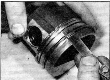
Рис. 12.2. Снимите поршневые кольца с помощью щупа
