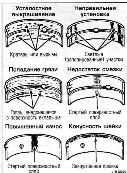
Рис. 14.2. Типичные неисправности подшипников
