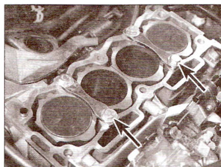
Рис. 11.17. Зажмите гильзы цилиндров перед проворачиванием коленчатого вала (зажимы отмечены стрелками) (двигатели 1.4 л)
