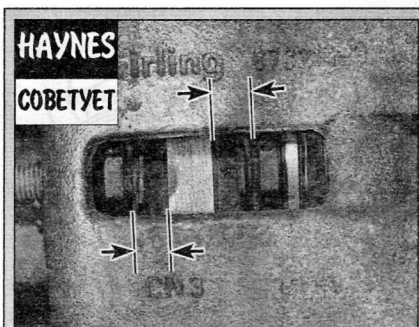
Быструю проверку толщины фрикционного материала на каждой тормозной колодке можно выполнить через проем в тормозном суппорте.
