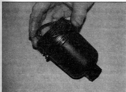
Рис. 3.11, б. ...и снимите уплотнительное кольцо
