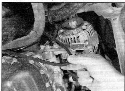
Рис. 10.9, б. ...затем снимите ремень со шкивов (модели с ручным регулятором на нижней опоре генератора)
