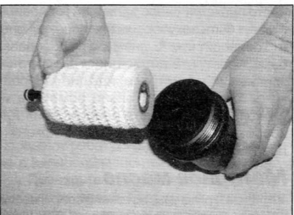
Рис. 3.14, а. Установите новый фильтрующий элемент в крышку...
