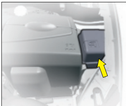
Предохранители в моторном отсеке
