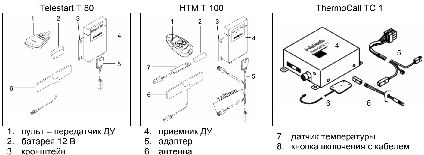
Рис. 26 Установочные комплекты систем ДУ предпусковых подогревателей Thermo Top
