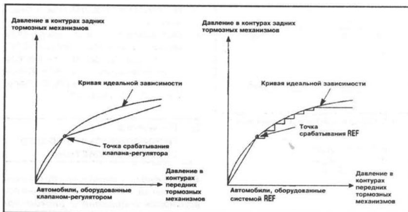
1.14 Сравнительные диаграммы, иллюстрирующие различие в принципах функционирования традиционного клапана-регулятора и системы REF
