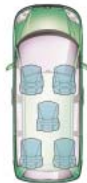
Вариант расположения сидений на пять посадочных мест
