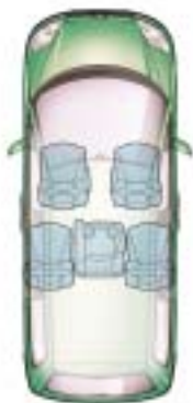
Вариант расположения сидений на пять посадочных мест
