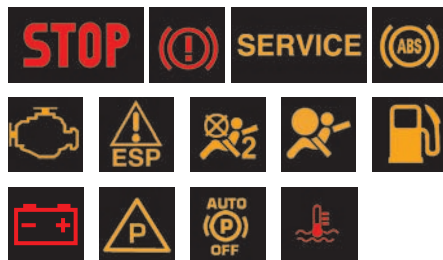
Тест с ключом в положении включенного зажигания
