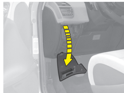
Доступ к первому блоку предохранителей под панелью управления
