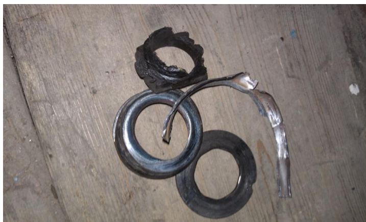
Фото 3 – Выжимной подшипник часть 2
