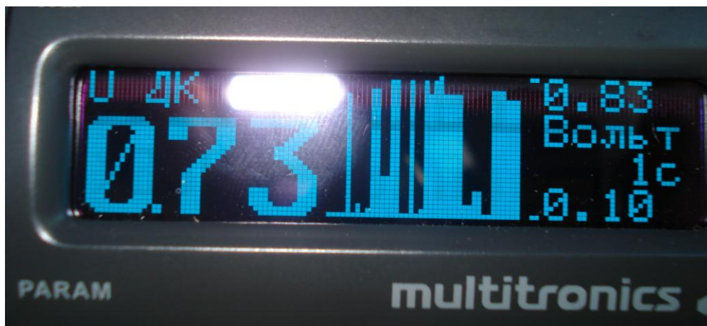
Фото 8 – Показания "Мультитроникса" со старым ДК (видна характерная нестабильность сигнала)
