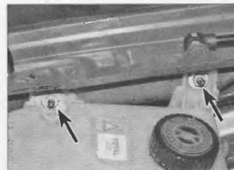
Рис. 17.6. Гайки крепления бачка гидравлической жидкости LDS (отмечены стрелками)
