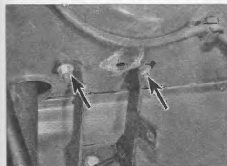
Рис. 17.5. Отверните две гайки (отмечены стрелками) в основании блока ВН1
