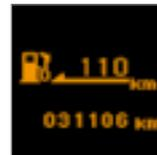
При работающем двигателе этот указатель показывает количество километров, которое еще можно пройти на оставшемся в баке запасе топлива в зависимости от среднего расхода топлива, рассчитанного по последним километрам.
