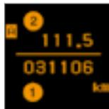
Общий пробег с начала эксплуатации автомобиля показан в зоне 1 дисплея, а протяженность пробега за поездку - в зоне 2 (См. гл. «Счетчики пробега»).
