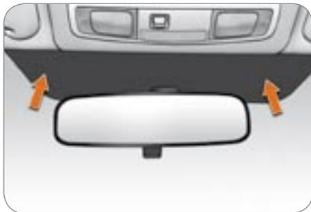
На атермальном ветровом стекле, над кронштейном внутрисалонного зеркала заднего вида, расположено окошко без теплоотражающего покрытия.
