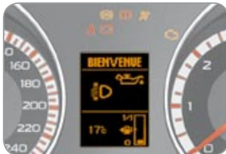
При включении зажигания загораются контрольные лампы оранжевого и красного цветов. При работающем двигателе они должны погаснуть.
