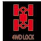
Режимы работы трансмиссии показываются на дисплее панели приборов сразу после включения каждого из них.
