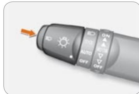
Для приведения в действие омывателей фар необходимо нажать на торцевую кнопку переключателя световых приборов, при этом фары ближнего света должны быть включены.
