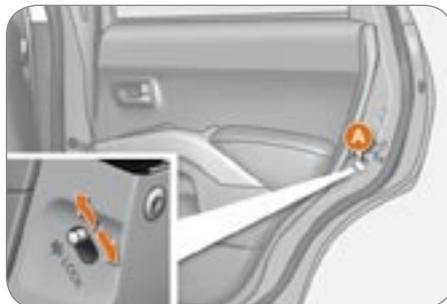
Специальный механизм блокировки замка не позволяет открыть соответствующую дверь из салона.
