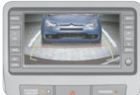
Связанная с бортовой навигационной системой видеочамера автоматически активируется при включении передачи заднего хода.
