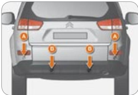
Чувствительные датчики способны обнаружить любое препятствие (пешехода, автомобиль, дерево, изгородь и т.д.), оказавшееся сзади на пути паркуемого автомобиля. Помехи, находящиеся непосредственно под бампером, датчиками не обнаруживаются.
