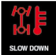
Если контрольная лампа режима работы трансмиссии мигает, автомобиль автоматически переключается в режим переднего привода «2WD».
