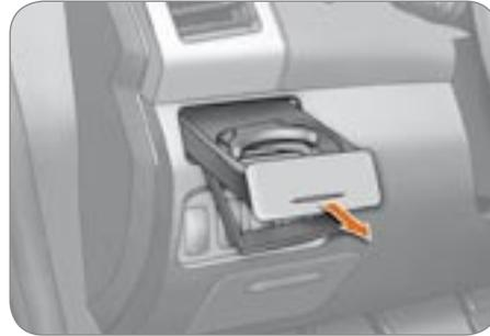
Со стороны водителя на панели приборов имеется подставка для стакана.
