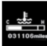
При работающем двигателе этот указатель показывает температуру охлаждающей жидкости (см. гл. «Указатель температуры охлаждающей жидкости»).
