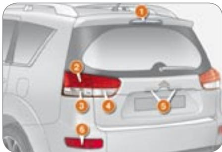
1. Третий фонарь стоп-сигнала (на светодиодах).
