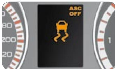
Загорание этого сигнализатора в правом верхнем углу дисплея панели приборов свидетельствует о том, что системы ASC и TCL отключены.
