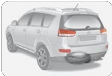
Неполноразмерное запасное колесо-«гале-та» расположено снаружи под полом багажного отсека на металлическом кронштейне.
