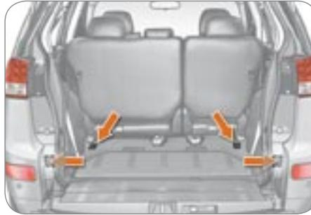
В багажном отсеке имеется четыре кольца для закрепления багажа:
