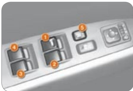
1. Выключатель стеклоподъемника двери водителя.
