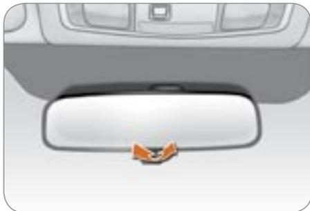
Настройте положение зеркала, поворачивая его в верхнем, нижнем, левом и правом направлениях.
