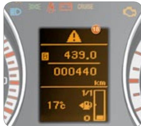
Это часть панели управления, на которой находятся контрольные приборы и сигнализаторы. Сигнализаторы информируют водителя о работе соответствующих систем (напр., контрольные лампы включения или отключения системы) или о появлении неисправности (предостерегающие сигнализаторы).
