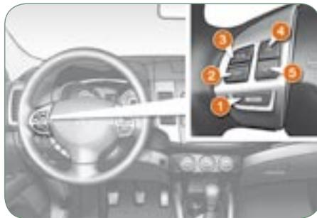
1. Выключатель с возможностью перехода от радиоприемника к CD-плееру
