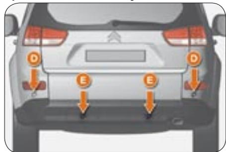
Система предназначена для обнаружения любых препятствий (людей, автомобилей, деревьев, бордюров и т.п.), расположенных позади автомобиля.
