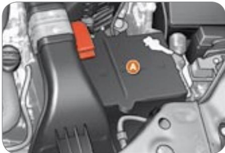
Аккумуляторная батарея **A** расположена под капотом слева.
