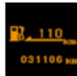
При работающем двигателе этот указатель показывает количество километров, которое еще можно пройти на оставшемся в баке запасе топлива в зависимости от среднего расхода топлива, рассчитанного по последним километрам (см. гл. «Запас хода по топливу»).
