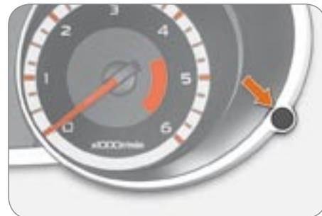
Независимо от того, включены или выключены световые приборы, нажмите на кнопку регулятора, чтобы изменить яркость подсветки панели приборов на «дневную» или «ночную».
