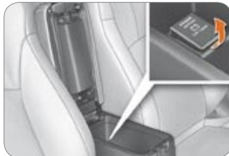
Розетка находится под напряжением, если ключ находится в замке зажигания в положении «LOCK», «ACC» или «ON».
