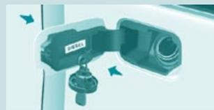
Специальный ограничитель не позволяет открыть левую боковую дверь, если крышка лючка топливного бака открыта.
