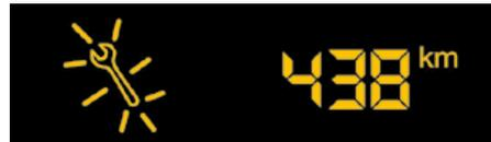
Несколько секунд спустя после включения зажигания начинает работать индикатор уровня масла, а счетчик общего пробега будет работать в обычном режиме, но символ гаечного ключа будет продолжать гореть, напоминая о необходимости пройти техническое обслуживание в ближайшие сроки.
