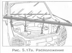
Рис. 5.17а. Расположение перекладины при вывешивании двигателей F8Q.
