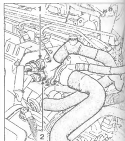
Рис. 3.91: 1 – Датчик сигнальной лампы; 2 – Датчик индикатора.
