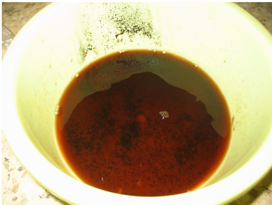
Фото 10 – Первая промывка, "кофе" – это осадок от бензина, "песок" – похоже на графит от щеток насоса (то, что возникло между фильтром сеткой и этим фильтром)
