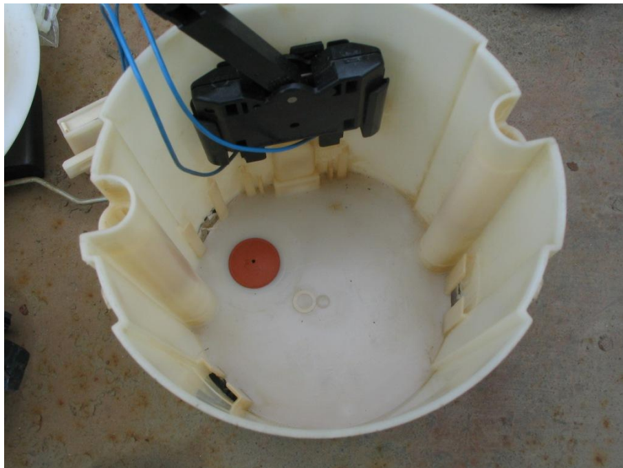
Фото 12 – стакан с клапаном на дне (новая сетка не должна его закрывать)
