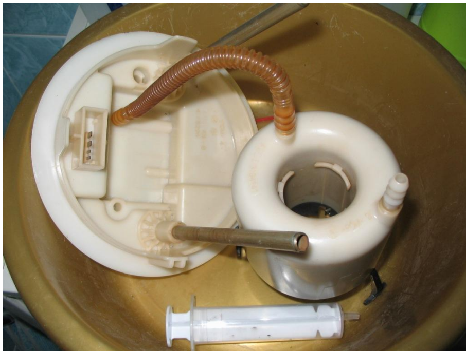
Фото 9 – Фильтр и крышка и "инструмент" для промывки
