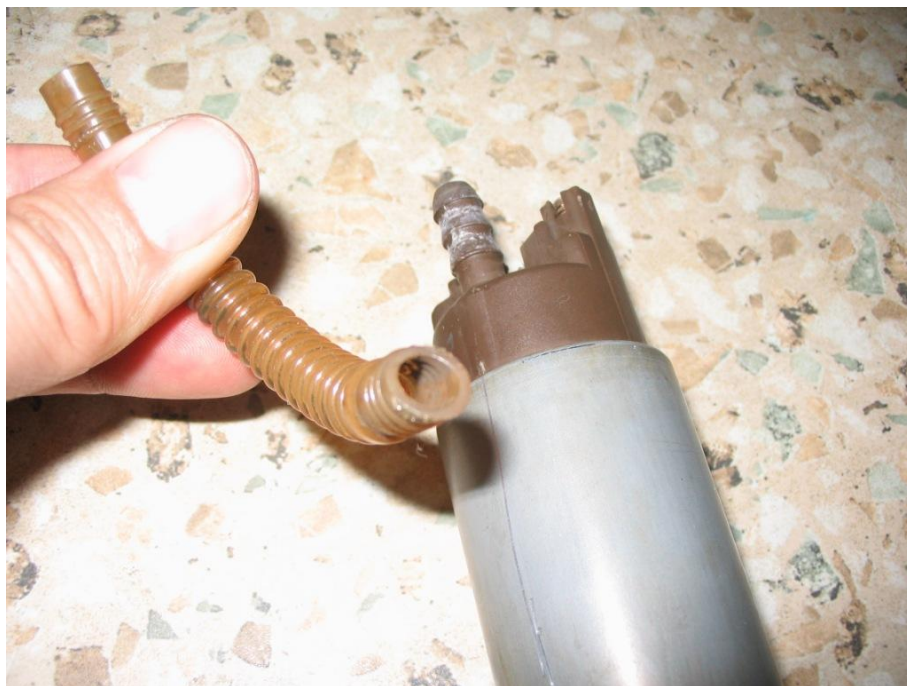
Фото 8 – Сам насос и грязь (графит) в его трубке
