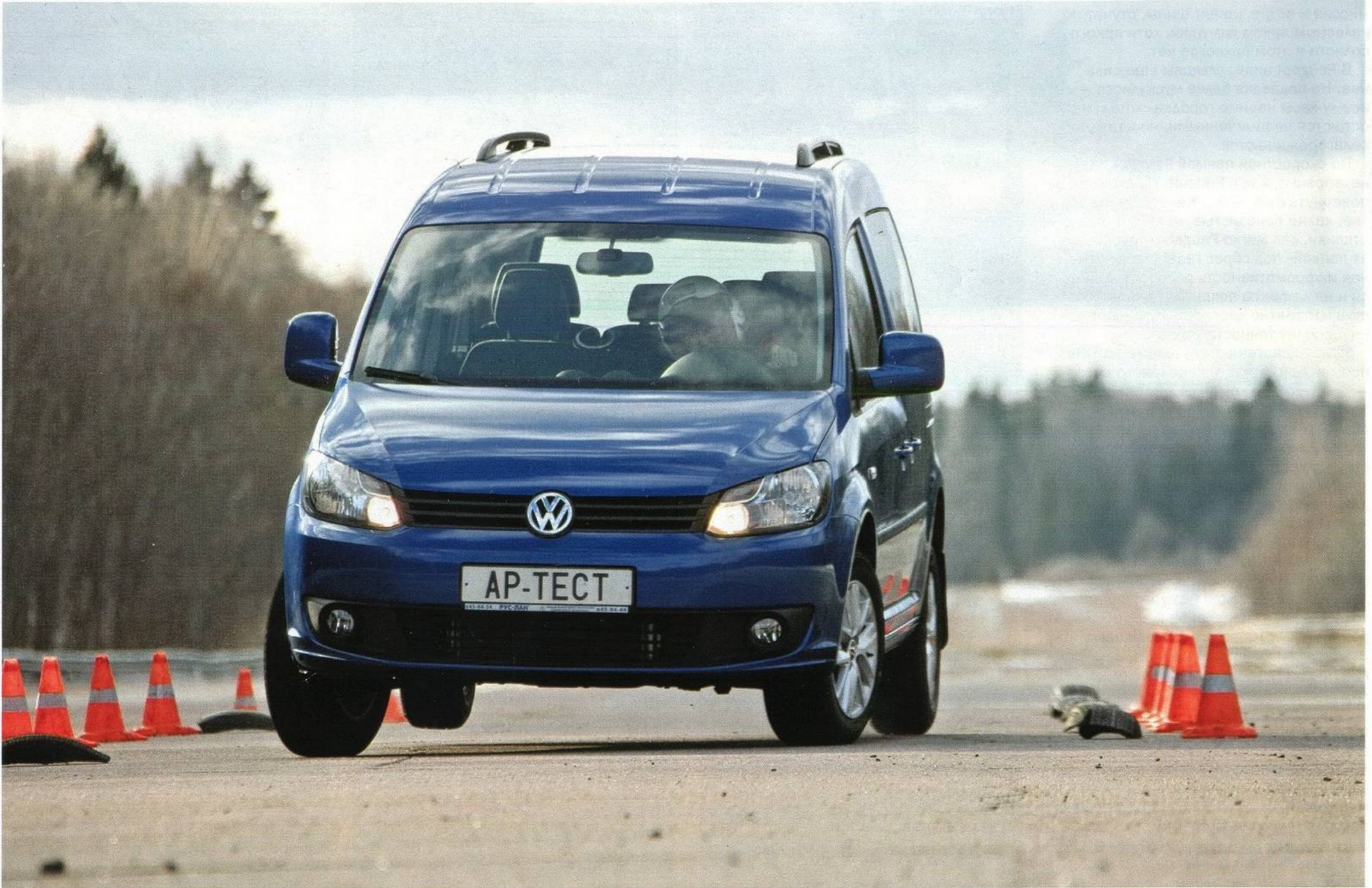
Caddy, как и Partner Теее, на «переставке» поднимает «заднюю ногу», но, в отличие от Kangoo, уверенно стоит на асфальте и не проявляет склонности к опрокидыванию
