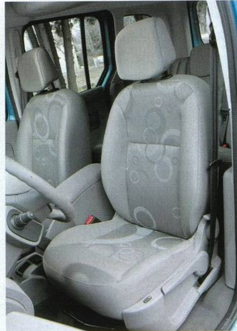
Чтобы отрегулировать наклон спинки плоско-аморфного кресла Renault, приходится открывать дверь — иначе кисть не пролезает к рычажку
