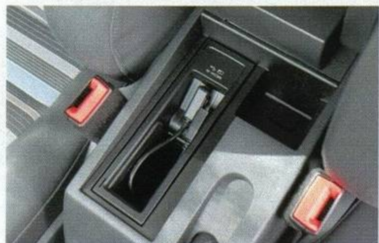
Бокс-подлокотник рассчитан на установку CD-чейнджера, но на нашей машине наличествовал только разъем для аудиоплеера
