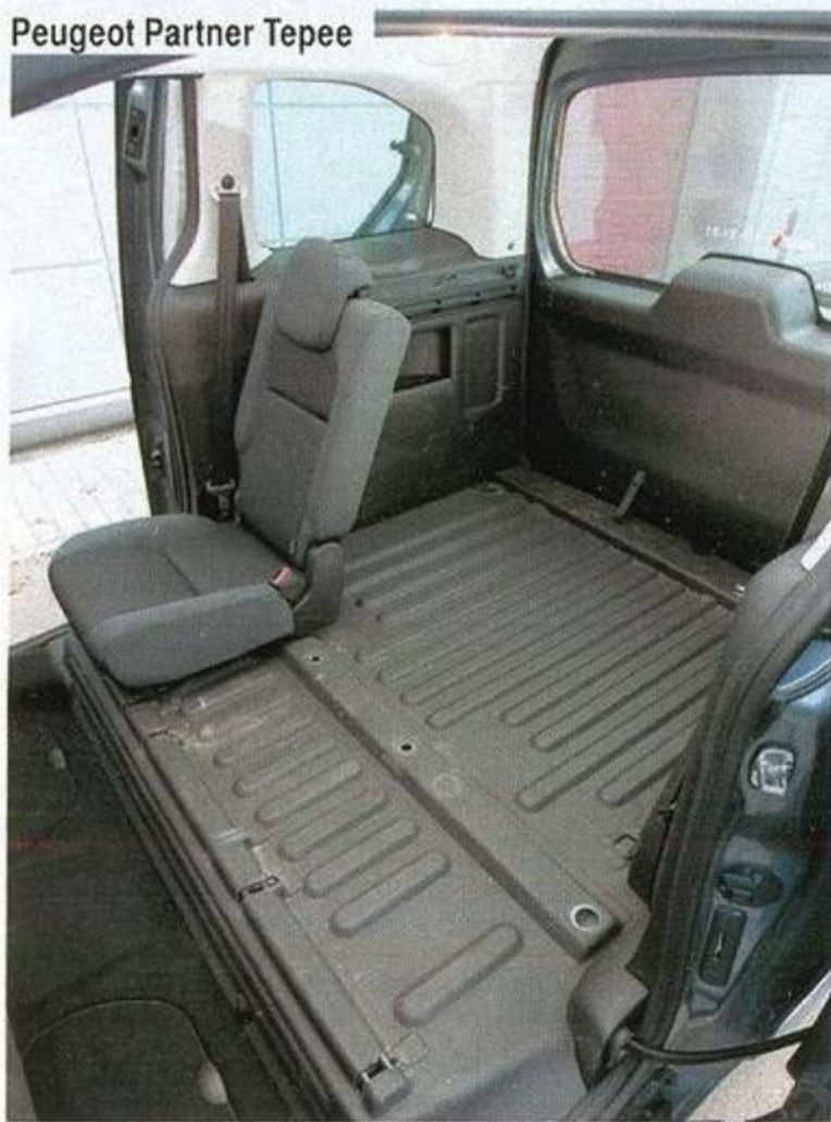
Абсолютно ровной грузовой платформы можно добиться только от Caddy, но мужчинам придется попотеть, а хрупким дамам будет и вовсе затруднительно вынуть тяжелые кресла из Фольксвагена. У Peugeot диван почти вдвое легче, однако под ними скрываются два «барьера», и фиксаторы работают менее четко. Сиденья из Renault не вынимаются, только складываются. При этом спинка ложится не «в горизонт», а с небольшим уклоном
