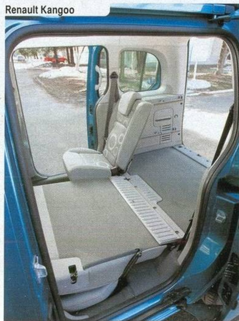
Абсолютно ровной грузовой платформы можно добиться только от Caddy, но мужчинам придется попотеть, а хрупким дамам будет и вовсе затруднительно вынуть тяжелые кресла из Фольксвагена. У Peugeot диван почти вдвое легче, однако под ними скрываются два «барьера», и фиксаторы работают менее четко. Сиденья из Renault не вынимаются, только складываются. При этом спинка ложится не «в горизонт», а с небольшим уклоном
