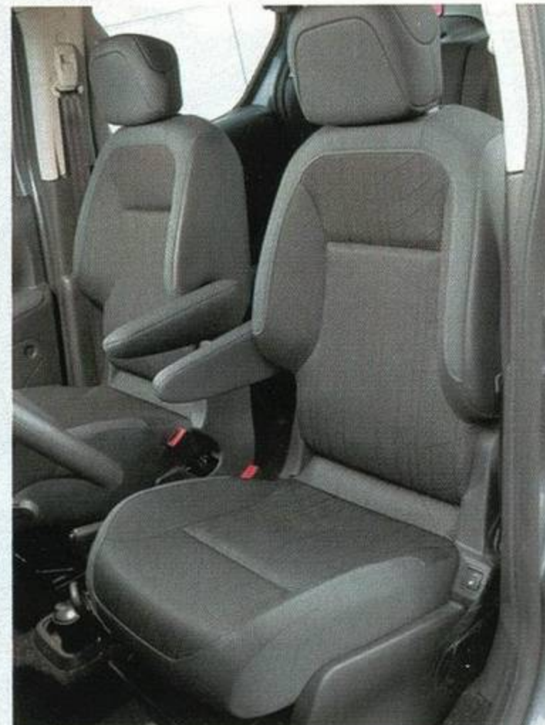
Чтобы изменить посадку в Peugeot с очень высокой на просто высокую, людям весом менее 75 кг придется попрыгать — рычаг регулировки высоты лишь разблокирует фиксатор, а само кресло подпружинено
