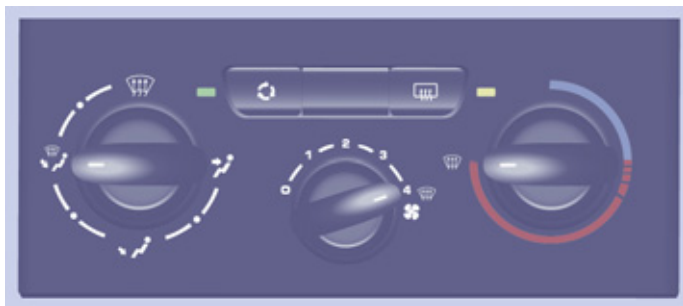
Панель управления отоплением
