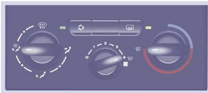
Панель управления отоплением
