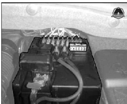
ПРЕДОХРАНИТЕЛИ НА АККУМУЛЯТОРНОЙ БАТАРЕЕ
